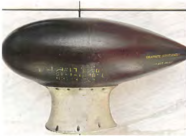
LP-21 gemotoriseerde antenne voor radiokompas in vliegtuigen, Verenigde Staten, WOII.
